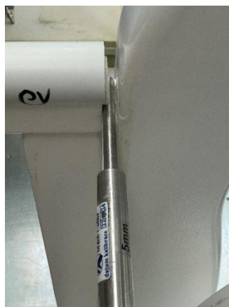
Obrázok č. 2 – Skúšanie dostupných miest strihu a stlačenia počas používania
