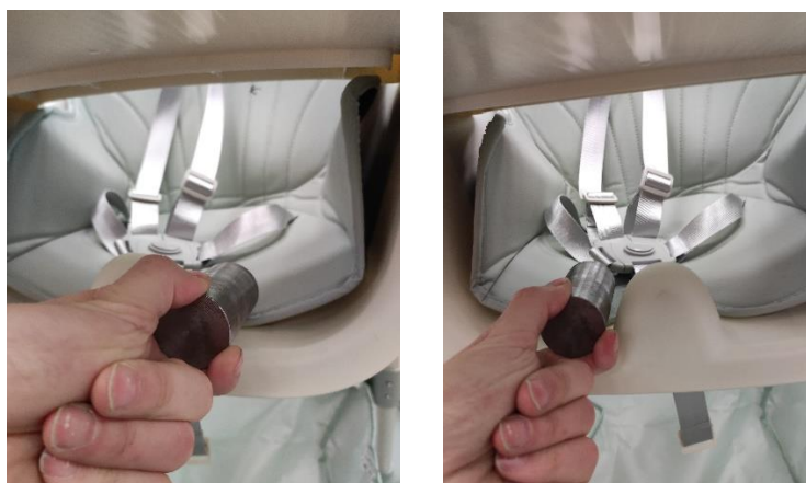
Obrázok č. 6 – Skúšanie medzier medzi otvormi na nohy
